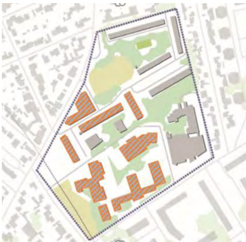
Figure 3 : Implantation des bâtiments actuels sur le périmètre. En orange, les bâtiments démolis ou à démolir. (source : dossier)
