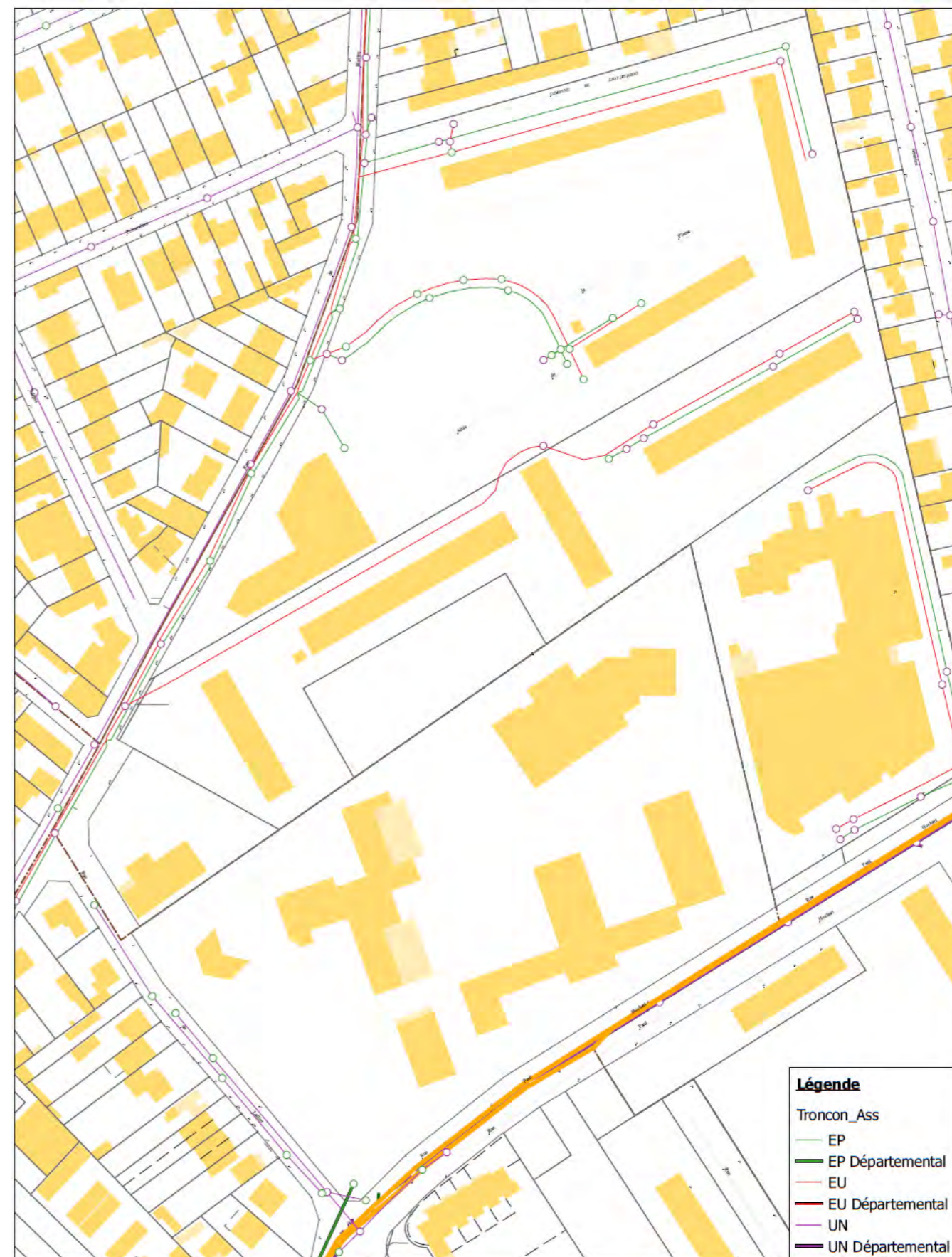
Réseaux d'assainissement sur le site Lallier – Source : Grand Orly Seine Bièvre
