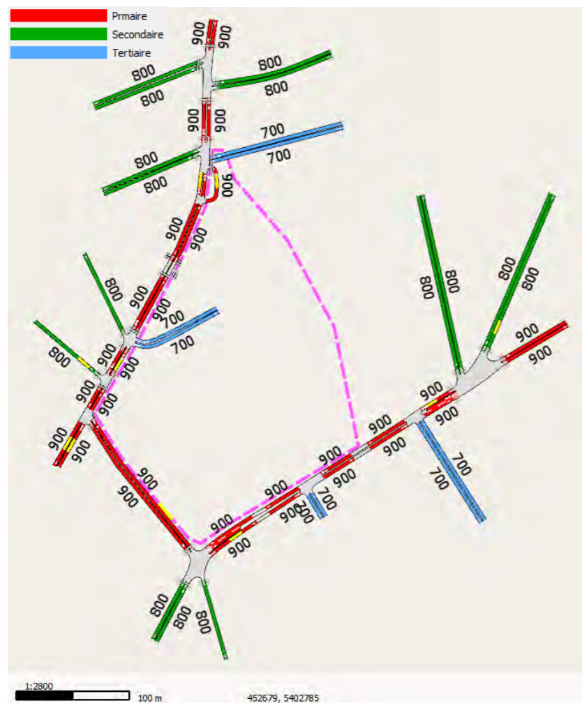
Figure 10 : hiérarchisation et capacité du réseau modélisé
